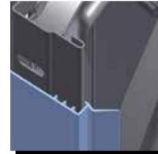
Joint à rupture thermique.
